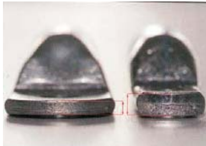
Slika 8: Debljina stopise na papučicama za razvodne ormare mora biti veća od standardne zbog identične mase
