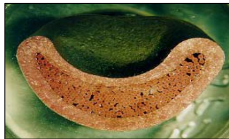
Slika 4: Presek kabla kod ubodnog presovanja sa prikazom jednakog rasporeda provodnika u spojnici.
