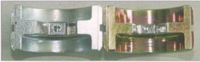
Slika 6: Kontaktne površine uloški za aluminijumske kablovske papučice (levo) je za 2mm šira nego kod njihovih bakarnih ekvivalenata (desno).
