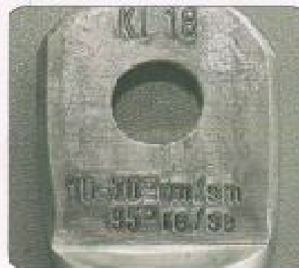
Slika 3: Oznake na papučicama označavaju proizvođača, veličinu vijka, poprečni presek i odrednicu kabla
