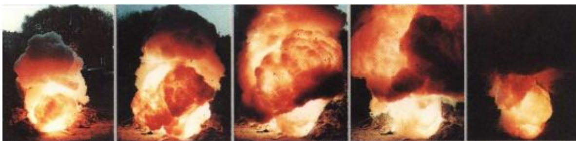
Luk (10.000 kV) koji se stvara sečenjem provodnika koj je pod naponom
